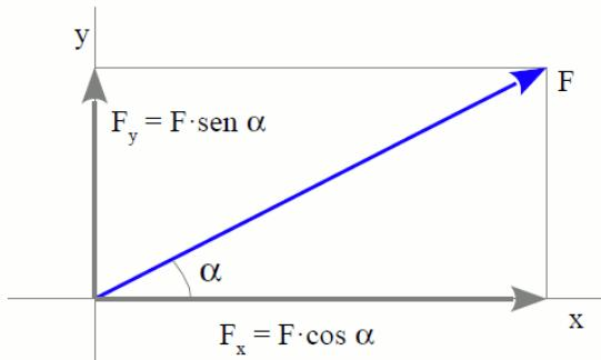
Estas componentes forman dos lados de un triángulo rectángulo, cuya hipotenusa tiene la magnitud de  $F$ . Así la magnitud y dirección de  $F$  están relacionadas con sus componentes por el teorema de Pitágoras, y la definición de tangente.
